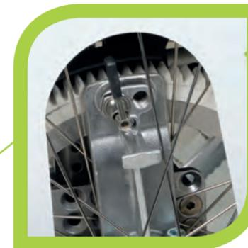
Durch einfaches Umlegen der Rasthebel in jedem Rad ist ein absoluter Freilauf möglich.
