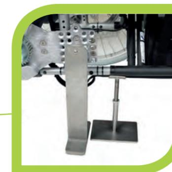
Ein Montageständersystem erleichtert die Montage der Halteplatte im Sanitätshaus.
