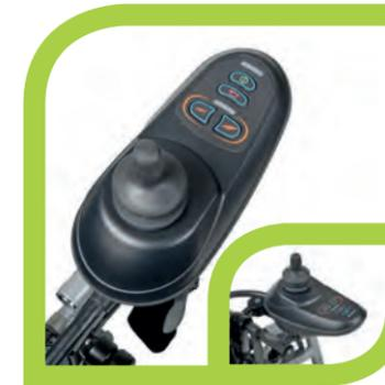
Die individuell programmierbare Joysticksteuerung kann links oder rechts montiert werden. Zum Anfahren an Tisch oder Hindernis wird die Steuerung zur Seite weggeschwenkt.
