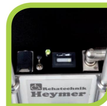
In dem Gehäuse befinden sich die Ladebuchse für den Akku, die Betriebsanzeige und die Akkuanzeige.
