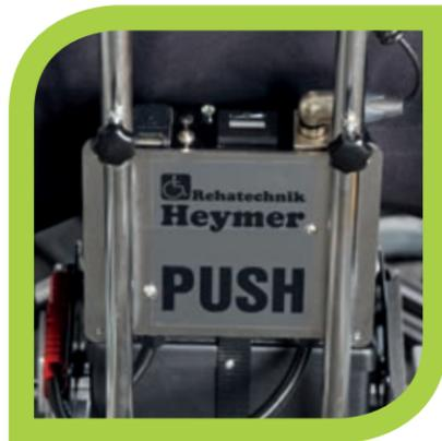
In dem Gehäuse befinden sich, gut erreichbar, die Ladebuchse für den Akku, die Betriebsanzeige und die Akkuanzeige.
