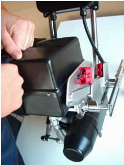
Bild 17 Einsetzen des Akkus
