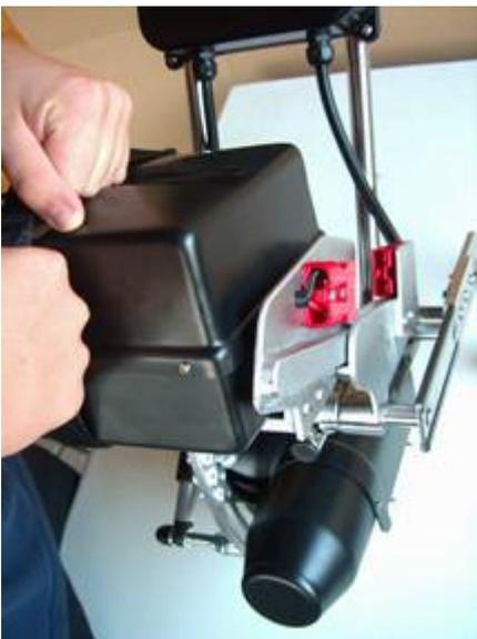
Bild 9 Einsetzen des Akkus
