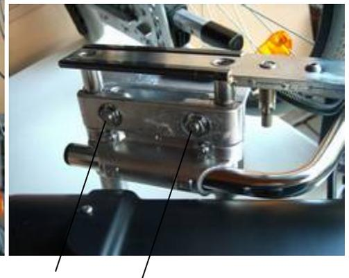
Bild 5, 5a: Antriebseinheit ohne Akku hinter Aufnahmen
