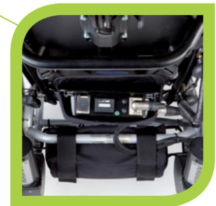
In der Rückentasche befindet sich, gut erreichbar, die Ladebuchse, die Betriebsanzeige und die Akkuanzeige.
