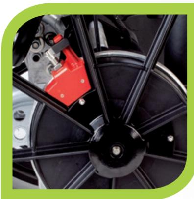
Durch einfaches Umlegen der Rasthebel in jedem Rad ist ein absoluter Freilauf möglich. Der Rollstuhl kann frei geschoben oder über die Greifreifen gefahren werden.
