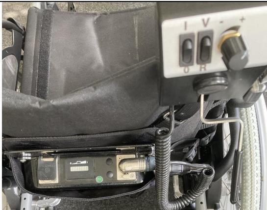
Bild 7 – Bedienteil, Bedienteilhalter + E-Einheit
