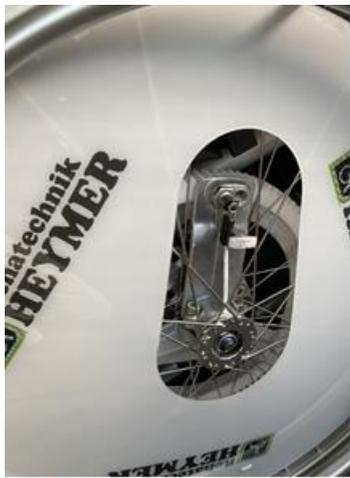
Bild 1 – Antriebsrad mit Freilauf
