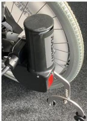
Bild 5 – Antriebsmotor mit Bremse
