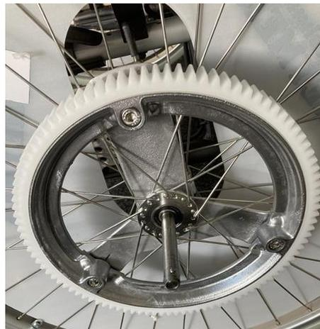
Bild 2 – Antriebsrad mit Freilauf
