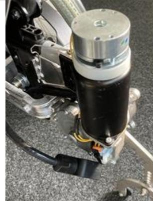
Bild 6 – Antriebsmotor mit Bremse
