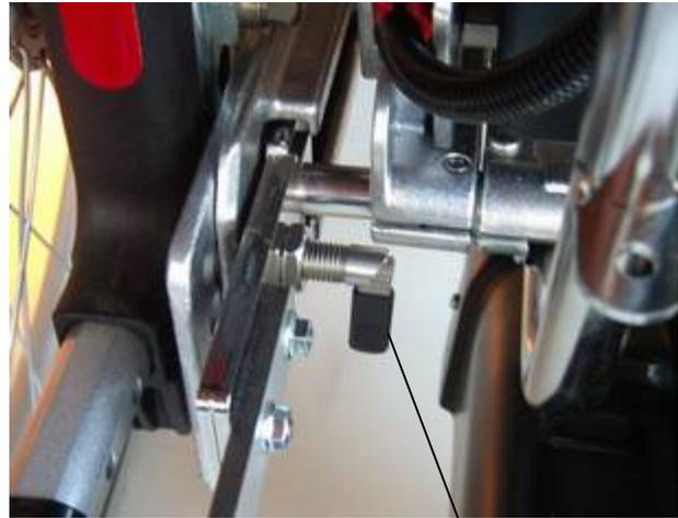
Bild 8: Hebel v. linkem Sicherungsbolzen unten, geschlossen
