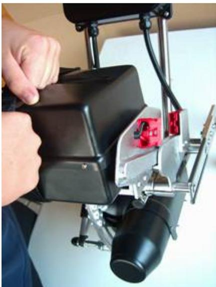
Bild 17 Einsetzen des Akkus
