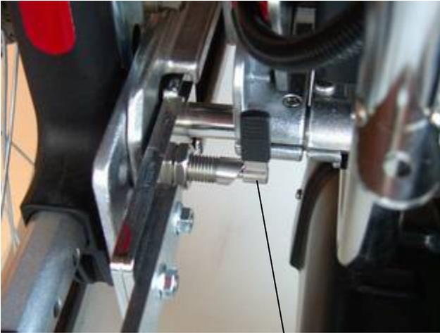
Bild 7: Hebel v. linkem Sicherungsbolzen oben, geöffnet
