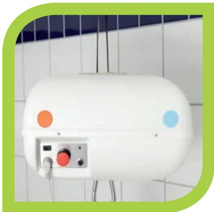
Die **Heymer Duo** hat eine Akkuanzeige, eine Funktionsanzeige, einen Not-Ausschalter, eine Ladebuchse und eine Notabsenkung.
