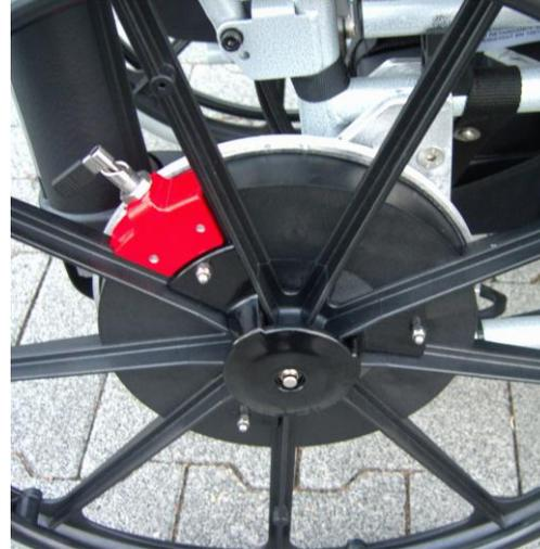
Bild 9 Bolzen bündig; Rad richtig angebaut
