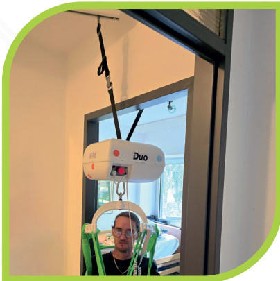
An der Tür angekommen, wird der zweite Tragegurt in die Schiene des nächsten Raumes eingehakt. Die Heymer Duo fährt per Knopfdruck unter dem Türsturz hindurch.
