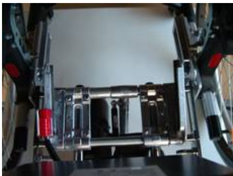
Bild 5, 5a: Antriebseinheit ohne Akku hinter Aufnahmen
