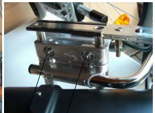
Bild 6: Spannrohrhalter zur Breitenverstellung
