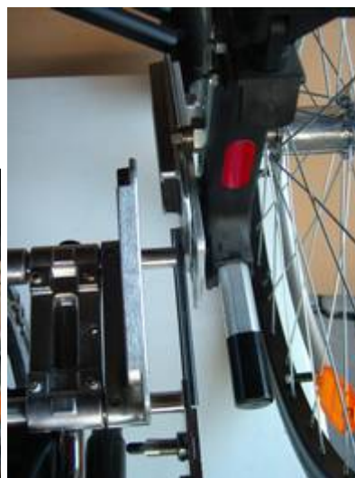
Bild 5, 5a: Antriebseinheit ohne Akku hinter Aufnahmen
