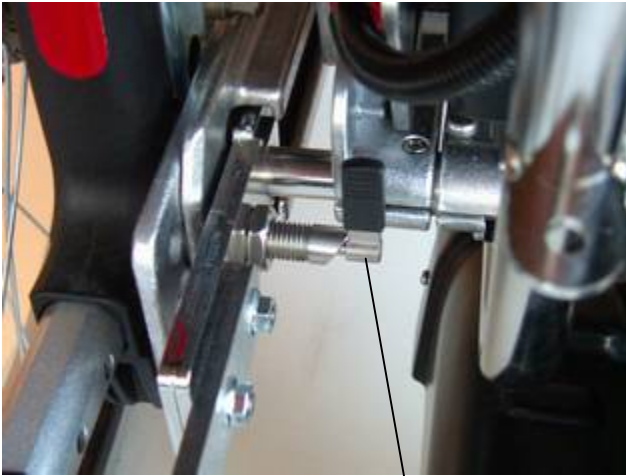
Bild 7: Hebel v. linkem Sicherungsbolzen oben, geöffnet
